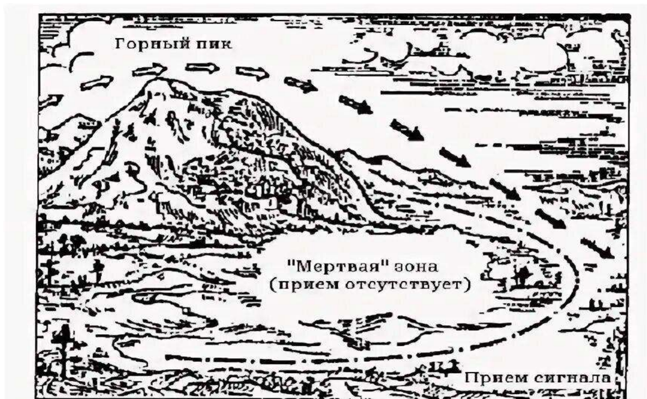
Рисунок 7- Способ распространения радиосигналов в горной местности
