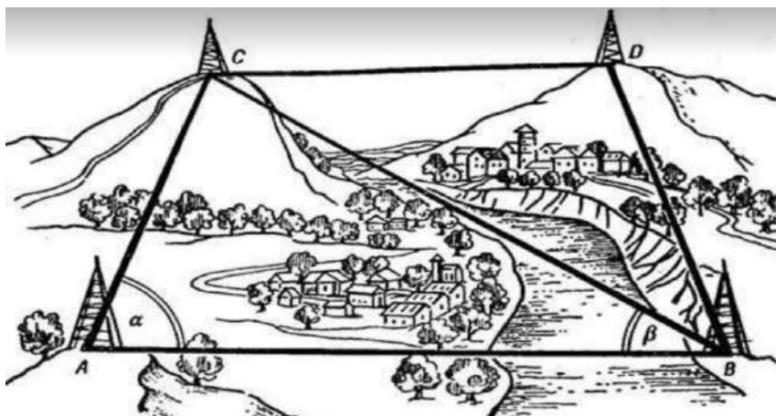
Рисунок 8- Схема угломерной триангуляции в горах
